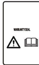
Das Chassis enthält Bauteile, die empfindlich gegenüber elektrostatischer Entladung (electrostatic discharge = ESD) sind. Das Chassis muss fachmännisch neu versiegelt werden. Aus diesen Gründen sollte das Chassis ausschließlich von autorisierten Servicetechnikern geöffnet werden. Wenn sie das Siegel zerstören, kann das zu teilweisem oder vollständigem Erlöschen der Garantie führen.
