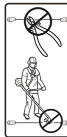
Das Niederspannungskabel darf weder gekürzt, verlängert noch gespleißt werden.
