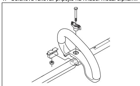
2. Posuňte vymedzovač do otvoru na oblúkovej rukoväti.
