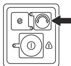
**Povšimněte si:** Pokud se strunová hlava otáčí ve směru hodinových ručiček, strunu lze snáze vysunout klepnutím.
