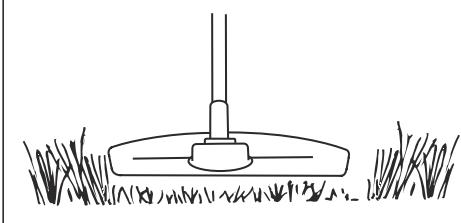
2. Netlačte hlavu vyžínače k zemi. Můžete tím výrobek poškodit.
