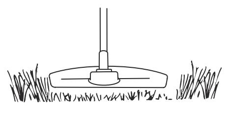
2. Netlačte vyžinaciu hlavu k zemi. Mohlo by to viesť k poškodeniu výrobku.
