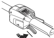
2. Posuňte poistku páčky vypínača (A) dopredu a dole. Podržte páčku vypínača proti rukoväti (B) a uistite sa, že keď ju pustíte, vráti sa do pôvodnej polohy.
