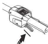
2. Stiskněte spouštěč a zkontrolujte, zda se po uvolnění vrátí do své původní polohy.
