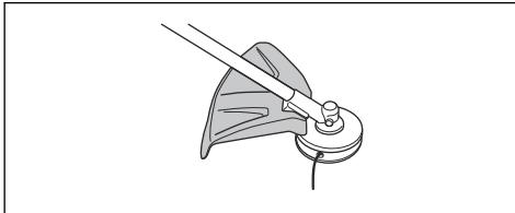
3. Poškozený kryt řezacího nástavce je nutné vyměnit.
