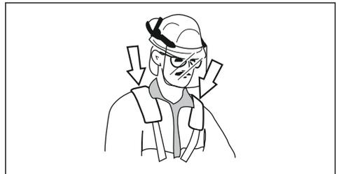
5. Stellen Sie den Tragegurt so ein, dass die Schneidusrüstung parallel zum Boden hängt.
