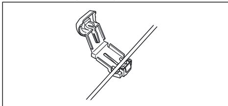
3. Schließen Sie die Steckverbinder mit einer Zange.
