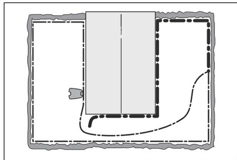
Fahren Sie fort, bis nur noch ein kurzes Teilstück den Unterschied zwischen einer dauerhaft grün leuchtenden und einer blau blinkenden Anzeigelampe ausmacht. Folgen Sie dann den Anweisungen in Schritt 5 unten.
