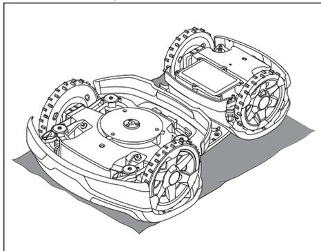
3. Reinigen Sie die Messerscheibe z. B. mit einer Spülbürste. Prüfen Sie gleichzeitig, ob sich der Messerteller frei drehen lässt und die Abdeckung zum Schutz der Füße nicht berührt. Stellen Sie auch sicher, dass die Klingen intakt sind und sich frei bewegen können.
