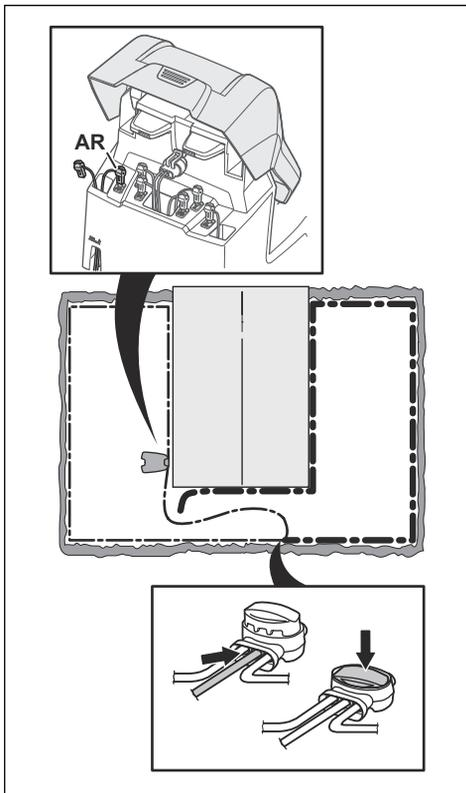
Leuchtet die Anzeigelampe jetzt grün, befindet sich der Bruch an einer Stelle zwischen dem ausgesteckten Ende und der Stelle, an der das neue Kabel angeschlossen wurde (dicke schwarze Linie unten). In diesem Fall das neue Kabel näher in Richtung ausgestecktes Ende verschieben (ungefähr in der Mitte des Bereichs, in dem der Bruch vermutet wird) und erneut prüfen, ob die Anzeigelampe grün leuchtet.
