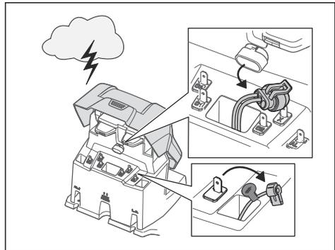
Um das Risiko der Beschädigung von Komponenten im Gerät und der Ladestation zu verringern, empfehlen wir, bei Gewittergefahr alle Verbindungen zur Ladestation (Stromversorgung, Begrenzungskabel und Leitkabel) zu trennen.
