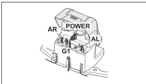
3. Anschlüsse von Leitkabel und Begrenzungskabel mit der Ladestation verbinden.
