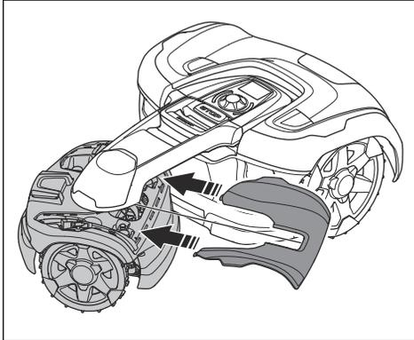
2. Bringen Sie die Abdeckung in Position (A) und drücken Sie auf die beiden Magnete, um die obere Abdeckung (B) anzubringen.
