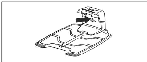
2. Prüfen, ob Begrenzungskabelanschlüsse an der Ladestation korrekt vorgenommen wurden und nicht beschädigt sind. Prüfen, ob die Anzeigelampe an der Ladestation noch immer blau blinkt.
