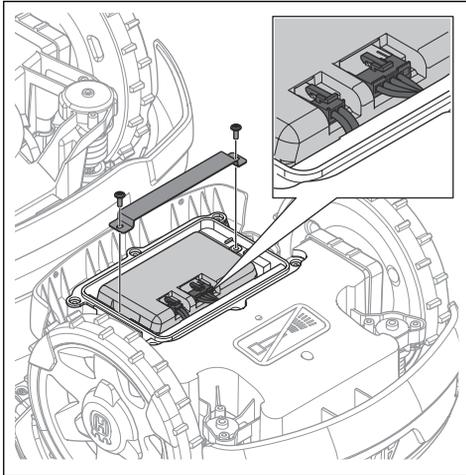
5. Entfernen Sie die beiden Kabel vom Akku und nehmen Sie den Akku heraus.
