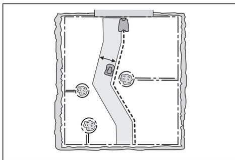
La largeur de couloir est ajustée automatiquement. Uniquement dans de rares cas, il convient de saisir des réglages manuels. La largeur de couloir peut être réglée entre 0-9. Si la largeur du couloir guide est réglée sur 0, le produit chevauche le câble guide. Le réglage d'usine est de 6 pour le câble périphérique et de 9 pour le câble guide.
