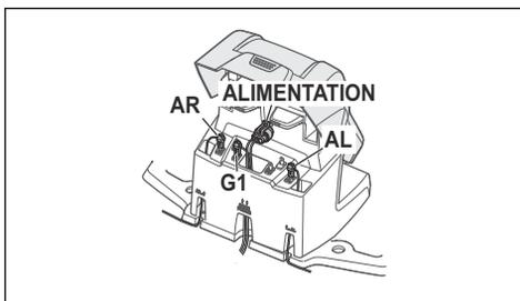
3. Échangez les branchements entre le câble guide et le câble périphérique de la station de charge.
