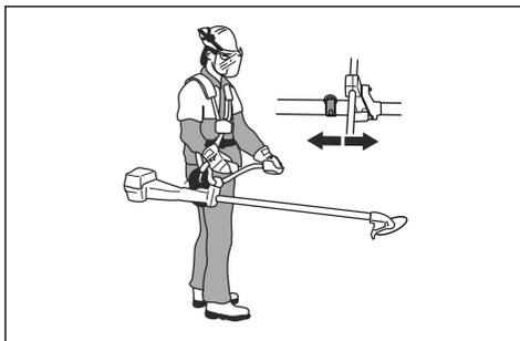
Beim Grasfreischneiden ist das Gerät korrekt ausbalanciert, wenn sich die Klinge auf Schnitthöhe in Bodennähe befindet.
