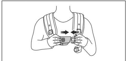
4. Wenn der Tragegurt über ein Hüftpolster und einen Hüftriemen verfügt, stellen Sie sicher, dass die Schnellösefunktion ordnungsgemäß funktioniert.
