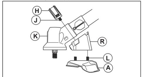
2. Odvijte oba vijaka (J) na ohišju opreme (K). Odstranite nosilec (R) in okvir (H).
