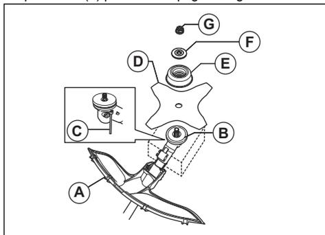
5. Poskrbite, da se pogonski disk in oporna prirobnica pravilno zaskočita v središčno odprtino noža za travo.
