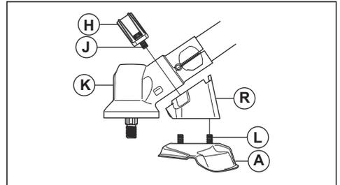
2. Entfernen Sie die zwei Schrauben (J) am Getriebegehäuse (K). Entfernen Sie die Halterung (R) und den Halter (H).
