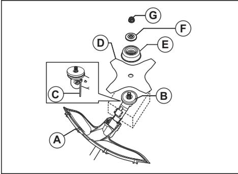
5. Stellen Sie sicher, dass das Mitnehmerrad und der Stützflansch korrekt im Mittelloch der Grasklinge einrasten.
