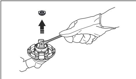
4. Entfernen Sie den Trimmerkopf.
