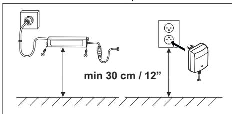
5. Brancher le câble du bloc d'alimentation à une prise de courant de 100 à 240 V.
