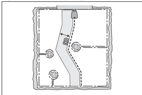
La largeur de couloir est réglée automatiquement. Il n'est nécessaire d'entrer les réglages manuels que quelques fois. La largeur de couloir peut être réglée entre 0 et 9. Si la largeur de couloir du guide est réglée à 0, le produit chevauchera le câble guide. Le réglage d'usine est de 6 pour le câble périphérique et de 9 pour le câble guide.
