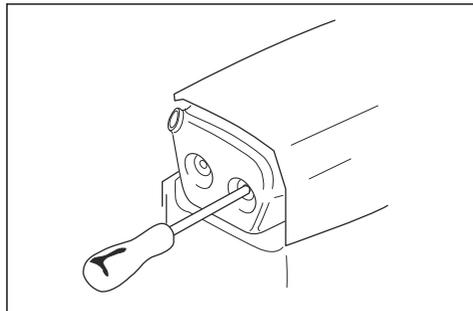
3. Če je izdelek opremljen s posebnim lovilnikom isker, ga morate čistiti enkrat tedensko.
