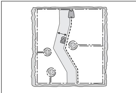
Die Korridorbreite wird automatisch eingestellt. Nur manchmal müssen manuelle Einstellungen vorgenommen werden. Die Korridorbreite kann zwischen 0 und 9 eingestellt werden. Wenn die Korridorbreite des Leitkabels auf 0 eingestellt ist, überfährt das Gerät das Leitkabel. Die Werkseinstellung ist 6 für das Begrenzungskabel und 9 für das Leitkabel.
