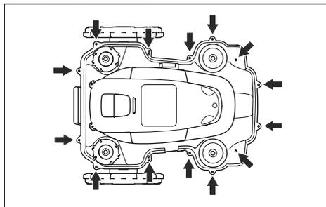
5. Heben Sie das Oberteil des Chassis an der Hinterkante an.
