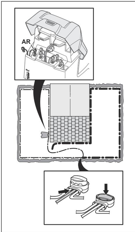
Leuchtet die Anzeigelampe jetzt grün, befindet sich der Bruch an einer Stelle zwischen dem ausgesteckten Ende und der Stelle, an der das neue Kabel angeschlossen wurde (dicke schwarze Linie unten). Verschieben Sie in diesem Fall das neue Kabel näher in Richtung ausgestecktes Ende (ungefähr in der Mitte des Bereichs, in dem der Bruch vermutet wird), und prüfen Sie erneut, ob die Anzeigelampe grün leuchtet.
