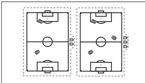
Die Installation des Begrenzungskabels und der Ladestationen muss parallel erfolgen. Der empfohlene Abstand (A) zwischen den Ladestationen beträgt 5 m/ 16 ft. Die maximale Breite des Arbeitsbereichs beträgt 70 m/230 ft.
