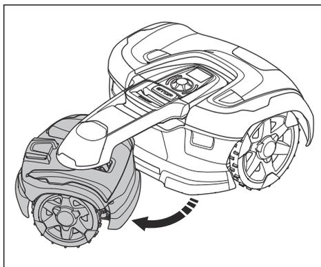
3. Placez une protection entre le capot et le bras de liaison. Cette précaution vise à éviter d'endommager le capot supérieur.
