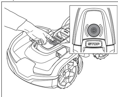
2. Appuyez sur le bouton **ON/OFF** pendant 3 secondes pour mettre le produit hors tension.
