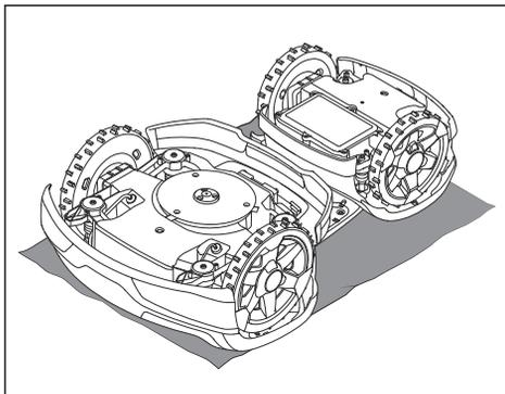
3. Retirez les 6 vis et déposez le capot de batterie.
