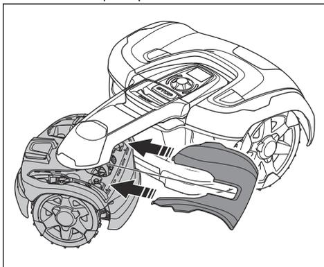
2. Placez le capot supérieur en position (A) et enfoncez les 2 aimants pour assembler le capot supérieur (B).
