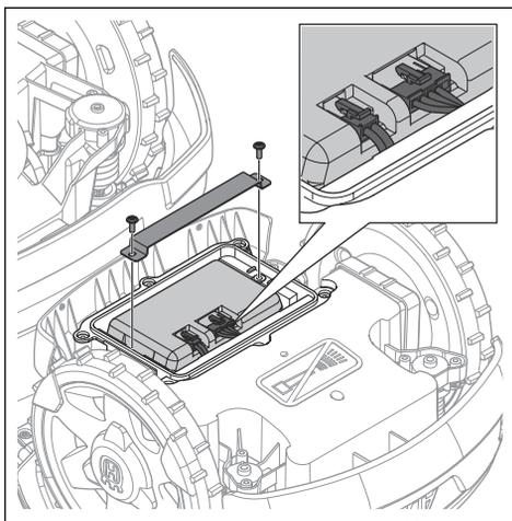
5. Déconnectez les deux câbles de la batterie et retirez la batterie.
