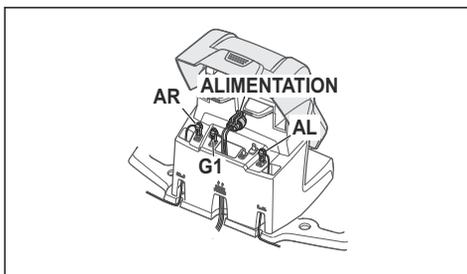
3. Échangez les raccordements entre le câble guide et le câble périphérique de la station de charge.
