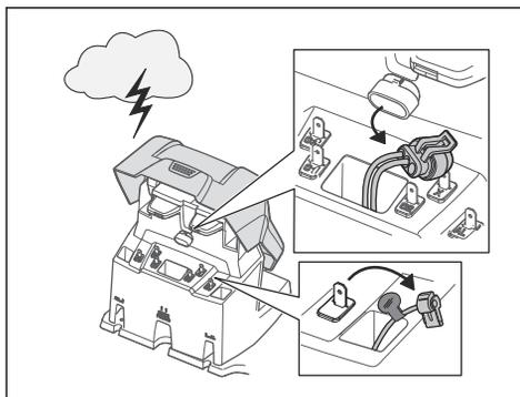
Pour réduire le risque d'endommagement des composants électriques du produit et de sa station de charge, nous recommandons de défaire tous les branchements de la station de charge (alimentation électrique, câble périphérique et câble guide) en cas de risque d'orage.
