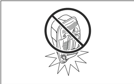
Der Schalldämpfer senkt den Geräuschpegel so weit wie möglich und hält die Abgase des Motors vom Anwender fern. In Bezug auf den Schalldämpfer ist es sehr wichtig, dass Sie die Kontroll-, Wartungs- und Serviceanweisungen stets befolgen.
