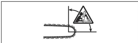
Ein Rückschlag ist immer in Richtung der Führungsschiene gerichtet. Normalerweise wird das Gerät gegen den Bediener geschleudert, manchmal aber auch in eine andere Richtung. Sie beeinflussen
