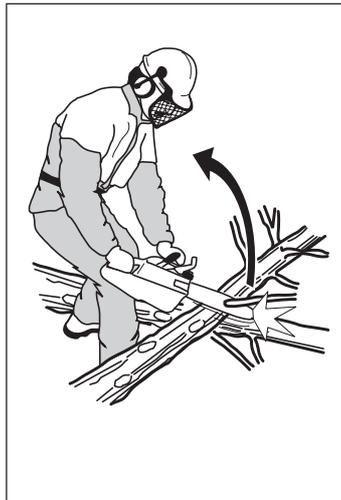
4 Die Säge darf niemals über Schulterhöhe benutzt werden und es ist zu vermeiden mit der Schienenspitze zu sägen.
