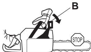
Diese Bewegung betätigt einen federgespannten Mechanismus, der das Bremsband (C) um das Kettenantriebssystem (D) des Motors spannt (Kupplungstrommel).
