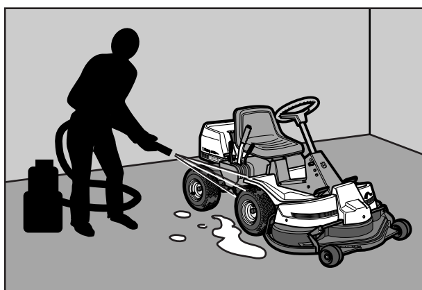
Nettoyez régulièrement la tondeuse autoportée pour enlever l'herbe, les feuilles et les autres impuretés.
