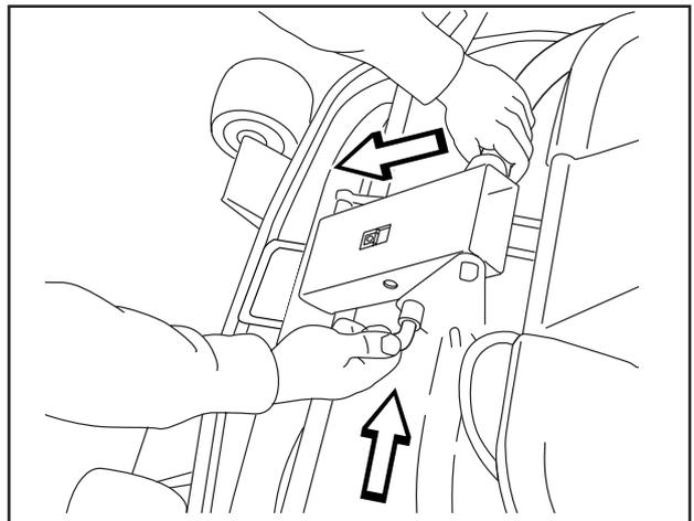
8. Das Aggregat an der Vorderkante anfassen, herausziehen und in die Servicestellung aufstellen.
