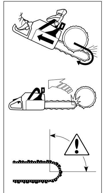
Il importe de résister à la poussée en arrière du guide-chaîne. En effet, si le guide-chaîne est repoussé assez en arrière pour que le nez se trouve à son tour engagé (zone dangereuse), un rebond peut se produire.
