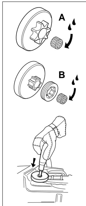
Tous les deux types ont un roulement à aiguilles à l'arbre de sortie qu'il faut être graissé régulièrement (une fois par semaine)
