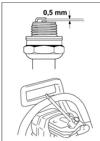
**Si la tronçonneuse ne donne pas sa pleine puissance, si elle est difficile à mettre en marche ou si le ralenti est irrégulier, toujours commencer par contrôler l'état de la bougie.** Si la bougie est encrassée, la nettoyer et vérifier que l'écartement des électrodes est 0,5 mm.
