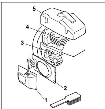
Une fois par semaine, nettoyer le système de refroidissement avec une brosse; dans les conditions sévères, plus souvent. **Un système de refroidissement sale ou colmaté provoque une surchauffe de la tronçonneuse, ce qui entraîne l'endommagement du cylindre et du piston.**
