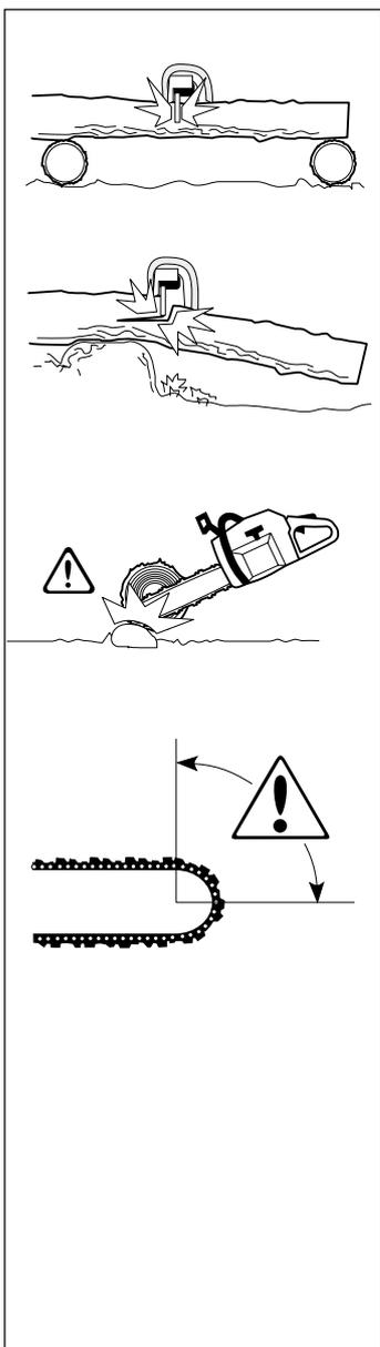
Si la chaîne se coince ou si la pièce à scier se casse, cela dépend de deux raisons : le support de la pièce avant et après le sciage, et l'état de tension de la pièce.
