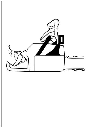
3 La plupart des accidents se produisent lors de l'ébranchage. Se tenir fermement sur les jambes. S'assurer que la zone de travail est bien dégagée, pour ne pas risquer de glisser ou de perdre l'équilibre. Ne pas tenir le nez du guide-chaîne au voisinage d'une souche, d'un rondin, d'une branche ou d'un arbre voisin auquel il risque de se cogner en cours de travail.
