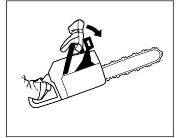
3 Le frein de chaîne sert de frein de stationnement de courte durée et pour le transport. Donc le frein de chaîne non seulement réduit les risques d'accident en cas de rebond mais, activé manuellement, constitue une mesure de sécurité.
