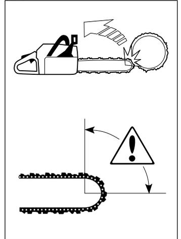
Le rebond se produit toujours dans le plan du guide-chaîne. En général, tronçonneuse et guide-chaîne sont relevés simultanément en direction de l'opérateur. Néanmoins, la direction du rebond peut varier suivant la position du nez au moment où il touche un objet quelconque.
