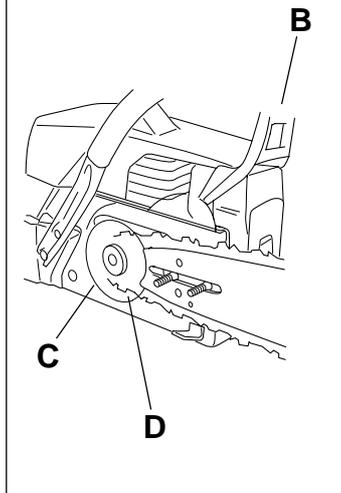
Ce mouvement active mécaniquement un ressort qui tend le ruban du frein (C) autour du système d'entraînement de la chaîne, autrement dit le "tambour d'embrayage" (D).
