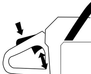
4 Mettre le tronçonneuse en marche et accélérer au maximum. Lâcher l'accélérateur et s'assurer que la chaîne s'arrête et reste en cette position. Si elle tourne tandis que la commande est au "ralenti", il faudra refaire le réglage de ralenti du carburateur. (Voir "Entretien").
