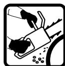
Toujours utiliser les deux mains pour manipuler la tronçonneuse. Prière de vous reporter à la page 30 de votre Manuel de sécurité de l'utilisateur d'une tronçonneuse.
