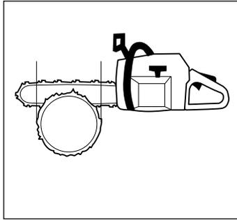
Il existe des méthodes d'abattage pour les troncs dont le diamètre est supérieur à la longueur du guide-chaîne. Ces méthodes comportent un risque important que la zone de rebond du guide-chaîne entre en contact avec un objet.
