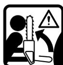
Un contact de la pointe peut provoquer un mouvement soudain du guide-chaîne vers le haut et l'arrière et ainsi causer des blessures graves. Prière de vous reporter aux pages 12 à 21 de votre Manuel de sécurité de l'utilisateur d'une tronçonneuse.
