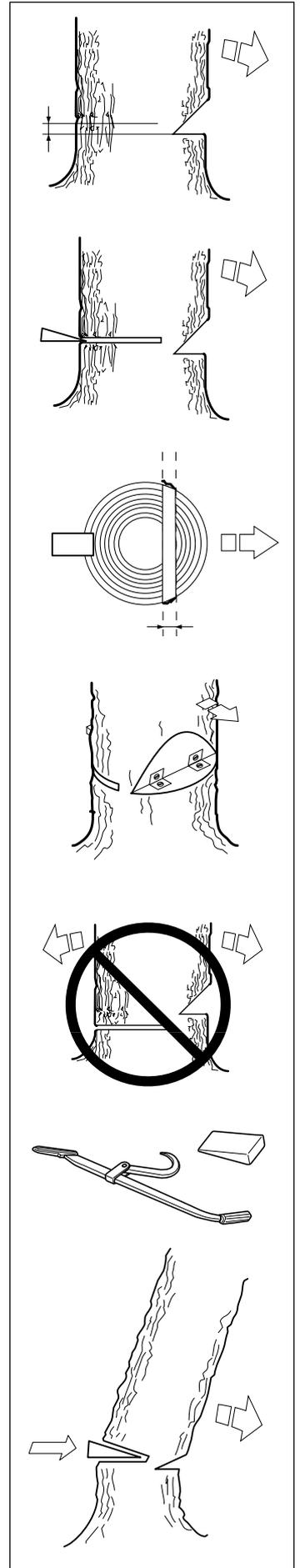
Scier à pleins gaz et enfoncer graduellement le guide-chaîne dans le tronc. Attention si l'arbre se déplace dans le sens opposé au sens de chute choisi. Introduire un COIN ou un BRAS DE LEVIER dans L'ENTAILLE D'ABATTAGE dès que la profondeur le permet.
