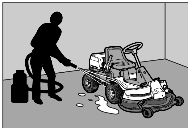
Nettoyez régulièrement la tondeuse autoportée, et enlevez l'herbe, les feuilles et tous les déchets.
