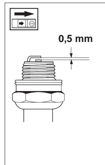
**Si la puissance de la machine est réduite, si la machine est difficile à démarrer ou si le régime de ralenti n'est pas régulier, contrôler en premier lieu l'état de la bougie d'allumage, avant de prendre d'autres mesures.**
