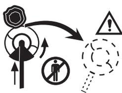
• Les machines équipées d'une lame d'éclaircissage ou à herbe peuvent projeter violemment sur le côté lorsque la lame rencontre un objet dur. La lame peut sectionner les bras ou les jambes. S'assurer que les personnes ou animaux restent à 15 mètres au minimum de la machine. Pour utiliser une lame d'éclaircissage ou à herbe, la machine doit être munie d'un guidon, d'un protège-lame et d'un harnais adaptés.
