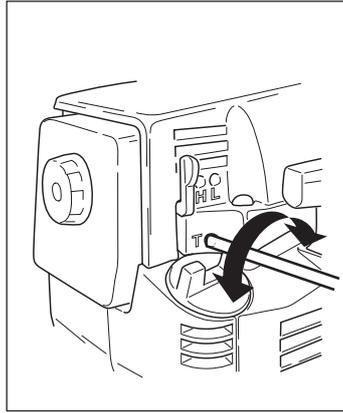
Un régime de ralenti correctement réglé permet au moteur de tourner régulièrement dans toutes les positions, en offrant une marge avant la mise en rotation de l'équipement de coupe.
