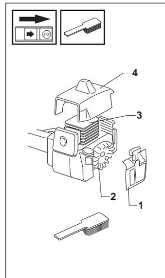
A l'aide d'une brosse, nettoyer le circuit de refroidissement une fois par semaine, en cas de conditions de service difficiles, plus souvent. **Un circuit de refroidissement encrassé ou obstrué entraîne une surchauffe du moteur pouvant résulter en des dommages au cylindre et au piston.**
