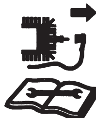
Arrêtez le moteur et enlevez le câble de la bougie d'allumage avant toute réparation ou entretien
