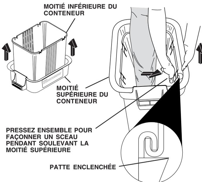
**VÉRIFICATION DE L'ENSEMBLE:** Pressez les côtés de la moitié inférieure du conteneur et vérifiez qu'il n'y ait pas un écart entre les moitiés supérieure et inférieure. Si un écart apparaît, déclenchez les pattes pour séparer les moitiés de conteneur et répétez les instructions ci-dessus.
