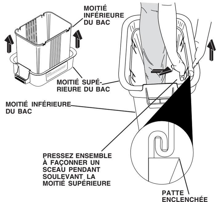
**VÉRIFICATION DE L'ENSEMBLE:** Pressez les côtés de la moitié inférieure du bac à gazon et vérifiez qu'il n'y a pas un écart entre les moitiés supérieure et inférieure. Si un écart apparaît, déverrouillez les pattes à séparer les moitiés de bac et répétez les instructions au-dessus.
