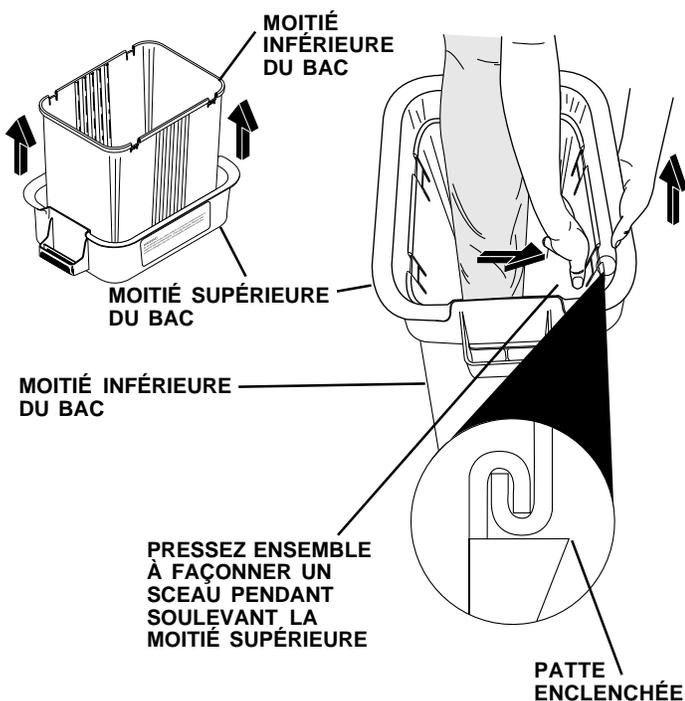
**VÉRIFICATION DE L'ENSEMBLE:** Pressez les côtés de la moitié inférieure du bac à gazon et vérifiez qu'il n'y a pas un écart entre les moitiés supérieure et inférieure. Si un écart apparaît, déverrouillez les pattes à séparer les moitiés de bac et répétez les instructions au-dessus.
