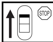
Couper le moteur en déplaçant l'interrupteur d'arrêt sur la position "STOP" avant d'entreprendre tout contrôle et/ou entretien.
