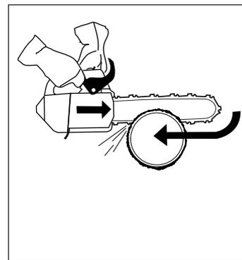
7 Suivre les instructions du fabricant relatives à l'affûtage et à l'entretien. N'utiliser que des pièces d'origine, et seulement les combinaisons chaîne et guide-chaîne recommandées. Voir au chapitre "Caractéristiques techniques", "Équipement de coupe".
