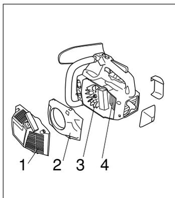
Une fois par semaine, nettoyer le système de refroidissement avec une brosse; dans les conditions sévères, plus souvent. **Un système de refroidissement sale ou colmaté provoque une surchauffe de la tronçonneuse, ce qui entraîne l'endommagement du cylindre et du piston.**
