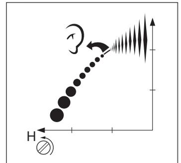
Le pointeau H de haut régime est correctement réglé si le moteur de la tronçonneuse tourne un peu à 4 temps. Si la tronçonneuse "siffle", le mélange est trop pauvre. Si le silencieux est trop bruyant alors que le moteur tourne longtemps à 4 temps, le mélange est trop riche. Tourner le pointeau H dans le sens des aiguilles jusqu'à obtention du son correct. **REMARQUE! Pour un réglage optimal du carburateur, contacter un technicien disposant d'un compte-tours.**
