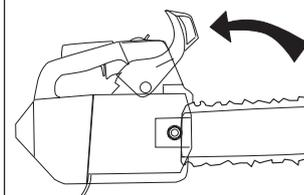
Réinitialiser le frein de chaîne en poussant la protection anti-rebond contre l'étrier de la poignée. La tronçonneuse est maintenant prête à être utilisée.
