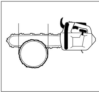
Il existe des méthodes d'abattage pour les troncs dont le diamètre est supérieur à la longueur du guide-chaîne. Ces méthodes comportent un risque important que la zone de rebond du guide-chaîne entre en contact avec un objet.
