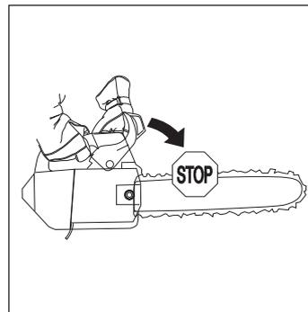
• Ne pas mettre la machine en route sans que le guide-chaîne, la chaîne et l'embrayage soient correctement montés. (Voir au chapitre "Montage").
