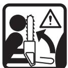
Un contact de la pointe peut provoquer un mouvement soudain du guide-chaîne vers le haut et l'arrière et ainsi être la cause de blessures graves.
