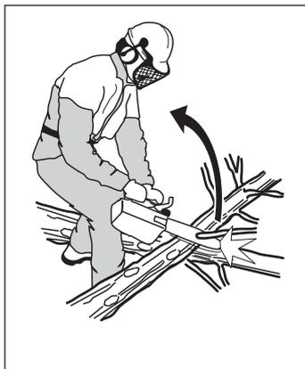
4 Ne pas utiliser la tronçonneuse en la tenant au-dessus des épaules. Éviter de couper avec la pointe du guide-chaîne.
