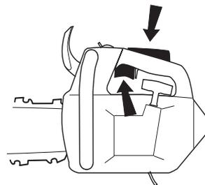
Amener le levier de commande en position intermédiaire (position de marche) dès que le moteur s'allume et répéter les lancements.
