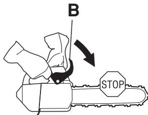
Ce mouvement active mécaniquement un ressort qui tend le ruban du frein (C) autour du système d'entraînement de la chaîne, autrement dit le "tambour d'embrayage" (D).
