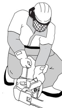
Le frein de chaîne étant encore activé, le régime du moteur doit être mis sur le ralenti le plus vite possible en déconnectant rapidement la gâchette d'accélération. De cette manière, toute usure inutile de l'embrayage, du tambour d'embrayage et de la bande de frein peut être évitée.
