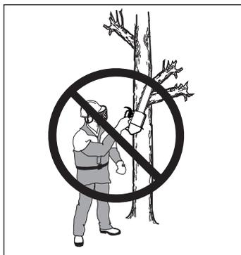
Pour couper les branches d'un arbre plus hautes que les épaules, il est recommandé d'utiliser une plate-forme ou un support de travail.
