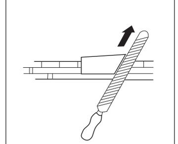
Zuerst alle Zähne der einen Seite schärfen, dann die Säge drehen und die Zähne der anderen Seite schärfen.
