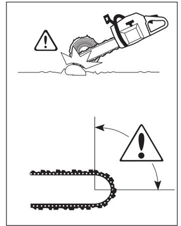
Wenn die Sägekette festklemt oder der Baumstamm bricht, ist dies auf zwei Faktoren zurückzuführen. Wie der Baumstamm vor und nach dem Ablängen gestützt wird und ob er unter Spannung steht.
