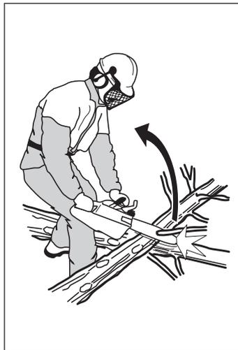
4 Die Säge darf niemals über Schulterhöhe benutzt werden und es ist zu vermeiden mit der Schienenspitze zu sägen. **Die Säge niemals mit nur einer Hand halten und benutzen.**
