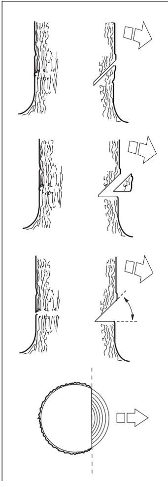
Dann einen Sägeschnitt von unten machen, bis man exakt auf den Sägeschnitt von oben trifft.
