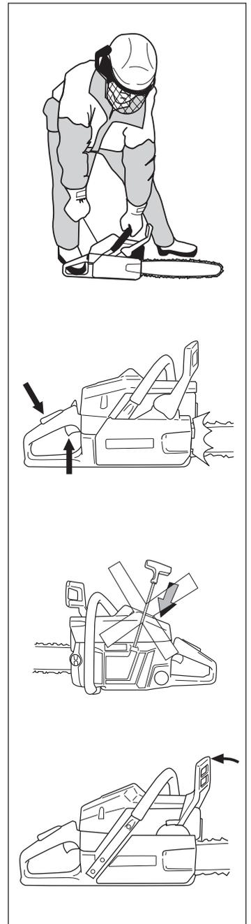
Da die Kettenbremse immer noch eingeschaltet ist, muss die Motordrehzahl so schnell wie möglich auf Leerlauf herunter, was durch ein schnelles Ausschalten der Gassperre erreicht wird. Dadurch vermeiden Sie unnötigen Verschleiß an Kupplung, Kupplungstrommel und Bremsband.
