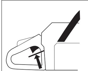
2 Die Gashebelsperre eindrücken und kontrollieren, ob sie in die Ausgangsstellung zurückkehrt, wenn sie losgelassen wird.
