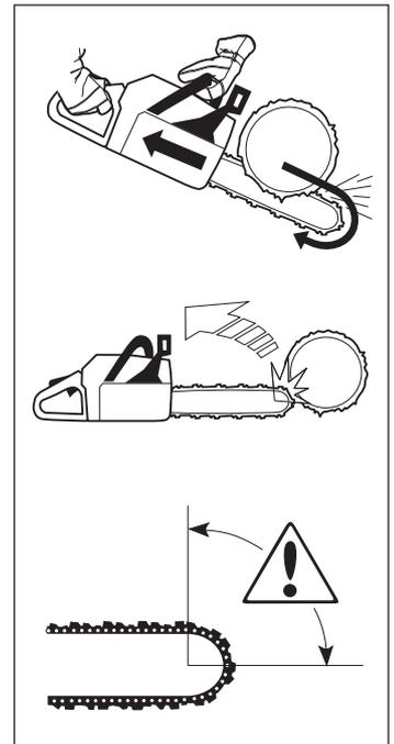
Das Sägen mit der Unterseite der Führungsschiene, d.h. von der Oberseite des Baumstammes nach unten, wird als Sägen mit ziehender Sägekette bezeichnet. Die Motorsäge wird zum Baumstamm hingezogen und die Vorderkante des Sägegehäuses funktioniert als natürliche Stütze am Stamm. Durch das Sägen mit ziehender Sägekette hat der Motorsägenführer eine bessere Kontrolle über die Motorsäge und über den Rückschlagbereich der Führungsschiene.
