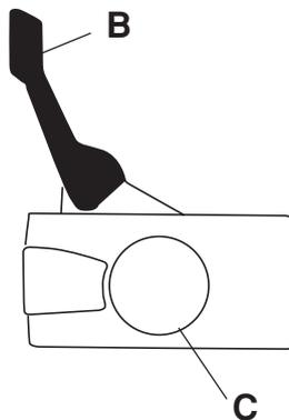
Diese Bewegung betätigt einen federgespannten Mechanismus, der das Bremsband (C) um das Kettenantriebssystem (D) des Motors spannt (Kupplungstrommel).
