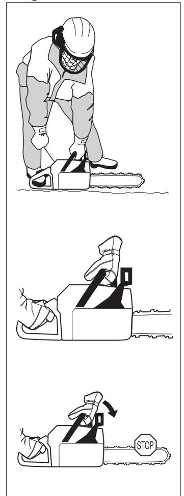
Halten Sie die Motorsäge in einem festen Griff, in dem Sie die Handgriffe fest mit den Daumen und Fingern umklammern.
