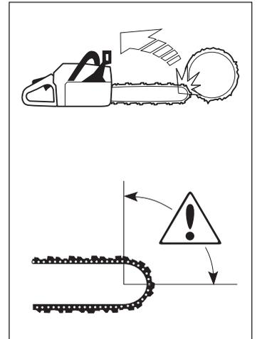
Ein Rückschlag ist immer in Richtung der Führungsschiene gerichtet. Am häufigsten erfolgt der Stoß von Motorsäge und Führungsschiene nach oben und nach hinten zum Motorsägenführer. Rückschläge erfolgen aber auch in andere Richtungen, je nachdem in welcher Stellung sich die Motorsäge in dem Augenblick befindet, in dem der Rückschlagbereich mit einem Gegenstand in Berührung kommt.
