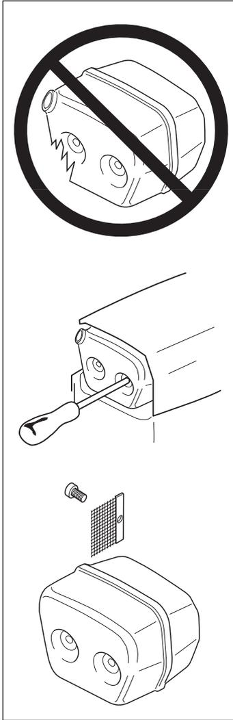
Regelmäßig kontrollieren, ob der Schalldämpfer in der Motorsäge ordentlich festmontiert ist.
