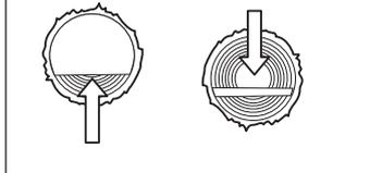
3 Der Stamm wird an beiden Enden gestützt. Es besteht die große Gefahr, daß die Sägekette festklemmt.
