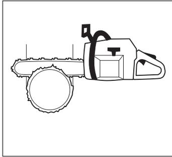
Es gibt zum Fällen von Bäumen Methoden, bei denen der Stammdurchmesser größer ist als die Führungsschielenlänge. Bei der Anwendung solcher Methoden besteht die große Gefahr, daß der Rückschlagbereich der Führungsschiene mit einem Gegenstand in Berührung kommt.
