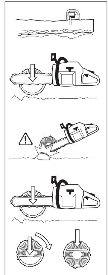
Von oben durch den ganzen Stamm sägen. Am Ende des Sägeschnittes ist Vorsicht geboten, um zu verhindern, daß die Sägekette den Erdboden berührt. Mit Vollgas weiterarbeiten, aber vorsichtig sein.
