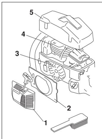
Das Kühlsystem einmal pro Woche mit einer Bürste reinigen, bei schwierigen Verhältnissen öfter. **Eine Verschmutzung oder Verstopfung des Kühlsystems führt zu einer Überhitzung der Säge, die Schäden am Zylinder und am Kolben zur Folge haben kann.**
