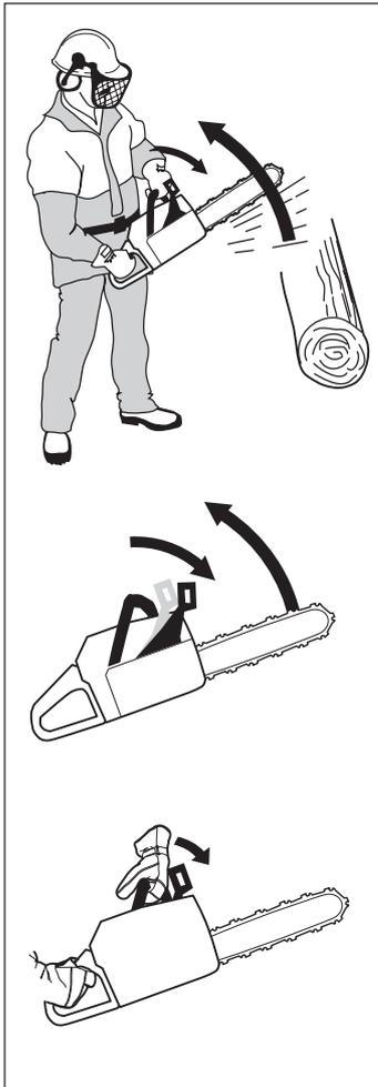
Bei weniger kräftigen Rückschlägen oder wenn sich der Rückschlagbereich in der Nähe des Motorsägenföhrers befindet, wird die Kettenbremse mit der linken Hand manuell betätigt.
