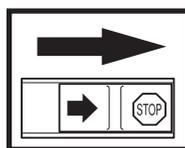
Kontrollen und/oder Wartungsmaßnahmen sind bei abgestelltem Motor durchzuführen, mit dem Stoppschalter in Stellung STOP.
