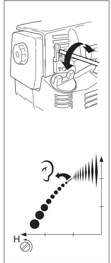
Le moteur ne doit pas être chargé lors du réglage du pointeau haut-régime. Démontez l'équipement de coupe, l'écrou, la bride de support et le toc d'entraînement avant d'effectuer le réglage du pointeau haut-régime. Le pointeau haut-régime H est correctement réglé quand le moteur démarre à quatre temps. Si le moteur s'emballe, le mélange de carburant est trop pauvre. Si le moteur tousse fortement et tourne à quatre temps, le mélange est trop riche.
