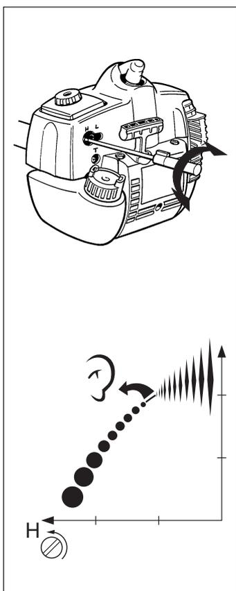
Le moteur ne doit pas être chargé lors du réglage du pointeau haut-régime. Démontez l'équipement de coupe, l'écrou, la bride de support et le toc d'entraînement avant d'effectuer le réglage du pointeau haut-régime. Le pointeau haut-régime H est correctement réglé quand le moteur démarre à quatre temps. Si le moteur s'emballe, le mélange de carburant est trop pauvre. Si le moteur tousse fortement et tourne à quatre temps, le mélange est trop riche.
