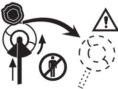
Les machines équipées d'une lame d'éclaircissage ou à herbe peuvent projeter violemment sur le côté quand la lame rencontre un objet dur. La lame peut sectionner les bras et les jambes. Toujours maintenir les personnes et les animaux à au moins 15 mètres de la machine.
