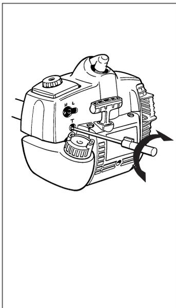
**AVERTISSEMENT!** S'il est impossible de régler le régime de ralenti pour immobiliser l'équipement de coupe, contacter le revendeur/atelier de service. Ne pas utiliser la machine tant qu'elle n'est pas correctement réglée ou réparée.
