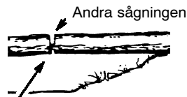
Första sågningen på den sida där stocken är utsatt för tryck
