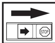
Contrôles et/ou entretiens doivent être effectués avec le moteur arrêté et le contacteur d'arrêt en position STOP.
