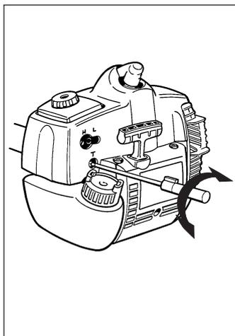
**AVERTISSEMENT!** S'il est impossible de régler le régime de ralenti pour immobiliser l'équipement de coupe, contacter le revendeur/atelier de service. Ne pas utiliser la machine tant qu'elle n'est pas correctement réglée ou réparée.
