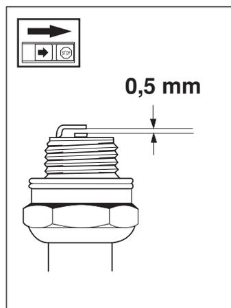
**Si la puissance de la machine est réduite, si la machine est difficile à démarrer ou si le régime de ralenti n'est pas régulier, contrôler en premier lieu l'état de la bougie d'allumage, avant de prendre d'autres mesures.**
