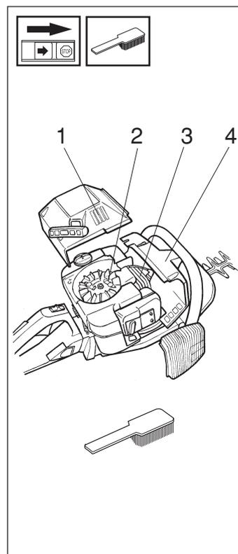
**Un circuit de refroidissement encrassé ou obstrué entraîne une surchauffe du moteur pouvant résulter en des dommages au cylindre et au piston.**
