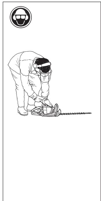
NOTER! Ne jamais sortir le lanceur entièrement, ne jamais lâcher le lanceur quand il est complètement sorti, cela risque d'endommager la machine.
