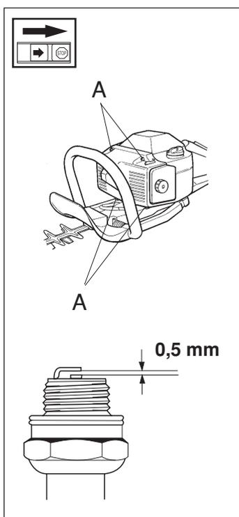
La bougie est accessible de sous le couvercle du cylindre qui se démonte en retirant les quatre boulons (A).
