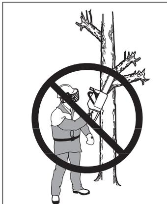
5 Afin de conserver le contrôle de la tronçonneuse, toujours conserver une position stable. Ne jamais travailler sur une échelle, dans un arbre ou sur tout autre support ne garantissant pas une bonne sécurité.
