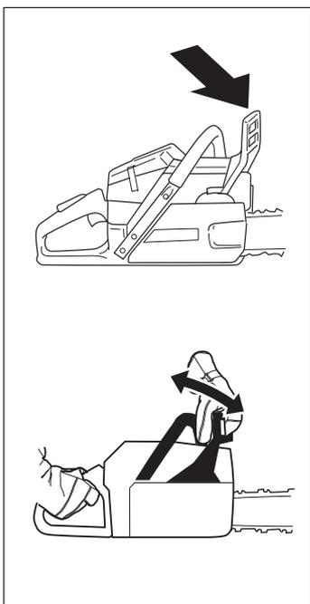
B Actionner l'arceau d'avant en arrière pour s'assurer qu'il se meut librement et qu'il est solidement fixé à son articulation dans le carter d'embrayage.
