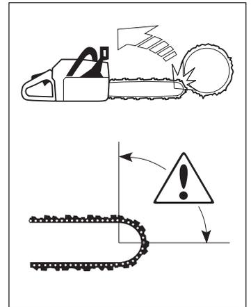
Le rebond se produit toujours dans le plan du guide-chaîne. En général, tronçonneuse et guide-chaîne sont relevés simultanément en direction de l'opérateur. Néanmoins, la direction du rebond peut varier suivant la position du nez au moment où il touche un objet quelconque.
