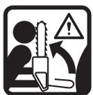
Un contact de la pointe peut provoquer un mouvement soudain du guide-chaîne vers le haut et l'arrière et ainsi causer des blessures graves.
