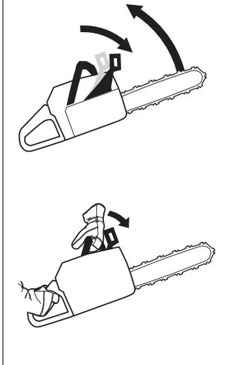
En position d'abattage, tenir la poignée avant de la main gauche ce qui ne permet pas d'activer manuellement le frein de chaîne. Dans cette position (la main gauche ne pouvant activer l'arceau de protection) le frein de chaîne ne peut être activé que par inertie.
