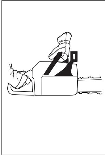
3 La plupart des accidents se produisent lors de l'ébranchage. Se tenir fermement sur les jambes. S'assurer que la zone de travail est bien dégagée, pour ne pas risquer de glisser ou de perdre l'équilibre. Ne pas tenir le nez du guide-chaîne au voisinage d'une souche, d'un rondin, d'une branche ou d'un arbre voisin auquel il risque de se cogner en cours de travail.
