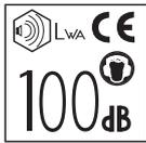
Émissions sonores dans l'environnement selon la Directive de l'Union européenne. Les émissions de la machine sont indiquées au chapitre CARACTÉRISTIQUES TECHNIQUES et sur l'autocollant.
