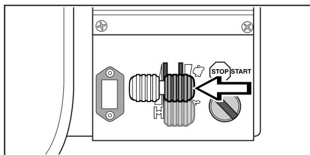
3. Si le moteur est froid, amenez le starter au maximum vers l'arrière.
