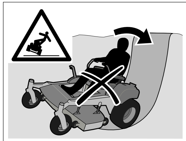
Observer la plus grande prudence lors de la conduite dans les pentes
