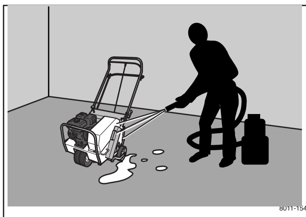
Diminuer le risque d'incendie en nettoyant la machine.
