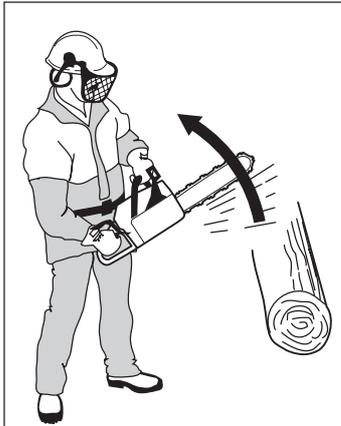
Bei weniger kräftigen Rückschlägen oder wenn sich der Rückschlagbereich in der Nähe des Motorsägenführers befindet, wird die Kettenbremse mit der linken Hand manuell betätigt.
