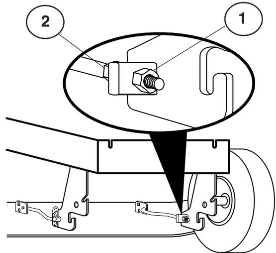
(S) För att få bästa klippresultat skall klippaggregatets framkant (B) vara ca 10 mm lägre än bakkanten (A). Justera på följande sätt för att höja bakkanten:
