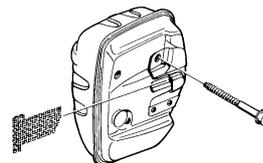
Bei Schalldämpfern ohne Katalysator sollte das Netz einmal in der Woche gereinigt und ggf. ausgetauscht werden. Bei Katalysatorschalldämpfern ist das Netz einmal im Monat zu kontrollieren und evtl. zu reinigen. **Beschädigte Netze sind auszutauschen.**
