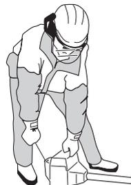
Den Choke sofort wieder in die Ausgangsstellung zurückführen, wenn der Motor zündet, und weitere Startversuche machen, bis der Motor anspringt. Wenn der Motor startet, schnell Vollgas geben und die Startgaslage wird automatisch ausgeschaltet.
