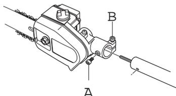
REMARQUE! S'assurer que l'arbre d'entraînement du tube de transmission pénètre dans la rainure de la tête de coupe.
