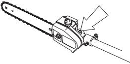
En général, il n'est pas nécessaire de remplacer le lubrifiant du carter, sauf en cas de réparations.
