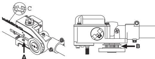
Tendre la chaîne en tournant la vis du tendeur de chaîne vers la droite à l'aide de la clé universelle. Tendre la chaîne jusqu'à ce qu'elle ne pende plus sous le guide.
