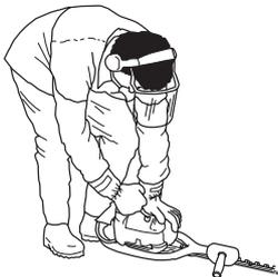
Den Choke sofort wieder in die Ausgangsstellung zurückführen, wenn der Motor zündet, und weitere Startversuche machen, bis der Motor anspringt. Wenn der Motor startet, schnell Vollgas geben und die Startgaslage wird automatisch ausgeschaltet.
