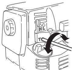
**REMARQUE!** S'il est impossible de régler le régime de ralenti de manière à immobiliser l'équipement de coupe, contacter le revendeur ou l'atelier de réparation. Ne pas utiliser la machine tant qu'elle n'est pas correctement réglée ou réparée.
