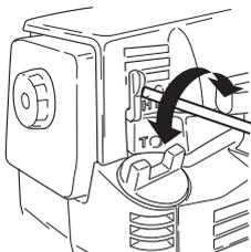
Le pointeau haut-régime H est correctement réglé quand on a un léger phénomène quatre temps. Si le moteur s'emballe, le mélange de carburant est trop pauvre. Si le moteur tousse fortement et qu'on a un phénomène quatre temps très prononcé, le mélange est trop riche.
