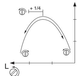
**ACHTUNG!** Wenn die Schneidausrüstung sich im Leerlauf dreht, ist die T-Schraube gegen den Uhrzeigersinn zu drehen, bis die Schneidausrüstung stehenbleibt.
