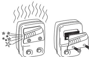
Für Schalldämpfer ist es sehr wichtig, dass die Kontroll-, Wartungs- und Serviceanweisungen befolgt werden. Siehe die Anweisungen unter der Überschrift Kontrolle, Wartung und Service der Sicherheitsausrüstung des Gerätes.
