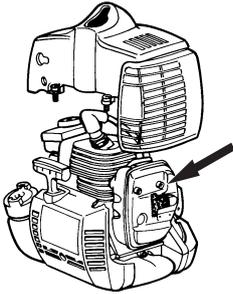
Bestimmte Schalldämpfer sind mit einem speziellen Funkenfangnetz ausgerüstet. Ist Ihr Gerät mit einem derartigen Schalldämpfer ausgestattet, so ist das Netz einmal wöchentlich zu säubern. Dies geschieht am besten mit einer Stahlbürste. Bei Schalldämpfern ohne Katalysator sollte das Netz einmal in der Woche gereinigt und ggf. ausgetauscht werden. Bei Katalysatorschalldämpfern ist das Netz einmal im Monat zu kontrollieren und evtl. zu reinigen. **Beschädigte Netze sind auszutauschen.**
