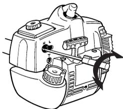
Vollgas geben und die Hochdrehzahldüse H sehr langsam im Uhrzeigersinn drehen, bis die Motorgeschwindigkeit abnimmt. Anschließend die Hochdrehzahldüse H sehr langsam gegen den Uhrzeigersinn drehen, bis der Motor ungleichmäßig läuft. Danach die Hochdrehzahldüse H langsam geringfügig im Uhrzeigersinn drehen, bis der Motor gleichmäßig läuft.
