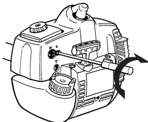
**AVERTISSEMENT!** S'il est impossible de régler le régime de ralenti de manière à immobiliser l'équipement de coupe, contacter le revendeur ou l'atelier de réparation. Ne pas utiliser la machine tant qu'elle n'est pas correctement réglée ou réparée.
