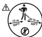
Les machines équipées d'une lame d'éclaircissage ou à herbe peuvent être projetées violemment sur le côté quand la lame rencontre un objet dur. La lame peut sectionner les bras et les jambes. Toujours maintenir les personnes et les animaux à au moins 15 mètres de la machine.
