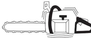
Die Vibrationen, denen der Anwender bei der Benutzung der Motorsäge ausgesetzt ist, entstehen durch den ungleichmäßigen Kontakt zwischen Sägekette und Baumstamm beim Sägen.
