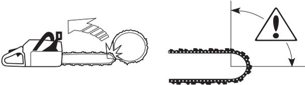
Das Sägen mit der Unterseite der Führungsschiene, d.h. von der Oberseite des Baumstammes nach unten, wird als Sägen mit ziehender Kette bezeichnet. Die Motorsäge wird zum Baumstamm hingezogen und die Vorderkante des Motorsägenkörpers fungiert als natürliche Stütze am Stamm. Beim Sägen mit ziehender Kette hat der Anwender eine bessere Kontrolle über die Motorsäge und über den Rückschlagbereich der Führungsschiene.
