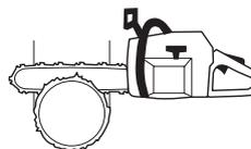
Es gibt Methoden zum Fällen von Bäumen, deren Stammdurchmesser größer ist als die Führungsschiene. Bei solchen Methoden besteht große Gefahr, dass der Rückschlagbereich der Führungsschiene mit einem Gegenstand in Berührung kommt.
