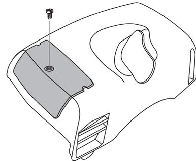
Diese vermindern die Kühlluft und verhindern das Einsaugen größerer Schneemengen in den Motor.
