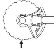
Beim Lösen und Anziehen der Sägeklingennutter besteht die Gefahr, dass man sich an den Zähnen der Sägeklinge verletzt. Daher darauf achten, dass die Hand bei dieser Arbeit durch den Klingenschutz geschützt ist. Immer einen Hülsenschlüssel mit ausreichend langem Schaft verwenden, damit dies möglich ist. Der Pfeil in der Abbildung zeigt, in welchem Bereich der Hülsenschlüssel beim Lösen bzw. Anziehen der Mutter arbeiten soll.
