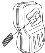
Niemals einen Schalldämpfer mit defektem Funkenfängernetz verwenden.
