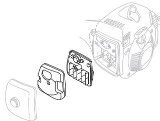
Wird die Maschine unter sehr staubigen Bedingungen eingesetzt, ist ein geöltes Filter aus Schaumstoff zu verwenden (Zubehör). Die Anweisungen zur Ölung sind im Kapitel Luftfilterölung enthalten.
