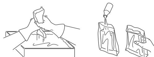
Ein Luftfilter, der längere Zeit verwendet wurde, wird nie vollkommen sauber. Der Luftfilter ist daher in regelmäßigen Abständen auszuwechseln. **Beschädigte Filter sind immer auszuwechseln.**
