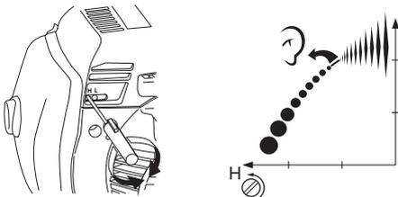
Bitte beachten, dass der Motor bei der Einstellung der Hochdrehzahldüse H unbelastet sein soll. Deshalb vor der Justierung der Hochdrehzahldüse H Schneidausrüstung, Mutter, Stützflansch und Mitnehmer demontieren.
