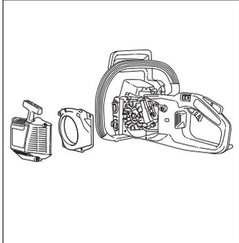
Une fois par semaine, nettoyer le système de refroidissement avec une brosse; dans les conditions sévères, plus souvent. **Un système de refroidissement sale ou colmaté provoque une surchauffe de la tronçonneuse, ce qui entraîne l'endommagement du cylindre et du piston.**
