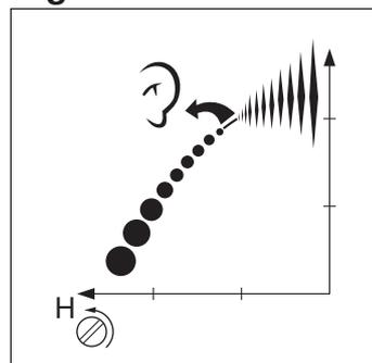
Le pointeau H de haut régime est correctement réglé si le moteur de la tronçonneuse tourne un peu à 4 temps. Si la tronçonneuse "siffle", le mélange est trop pauvre. Si le silencieux est trop bruyant alors que le moteur tourne longtemps à 4 temps, le mélange est trop riche. Tourner le pointeau H dans le sens des aiguilles jusqu'à obtention du son correct. **REMARQUE! Pour un réglage optimal du carburateur, contacter un technicien disposant d'un compte-tours.**
