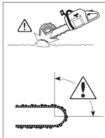
Si la chaîne se coince ou si la pièce à scier se casse, cela dépend de deux raisons : le support de la pièce avant et après le sciage, et l'état de tension de la pièce.
