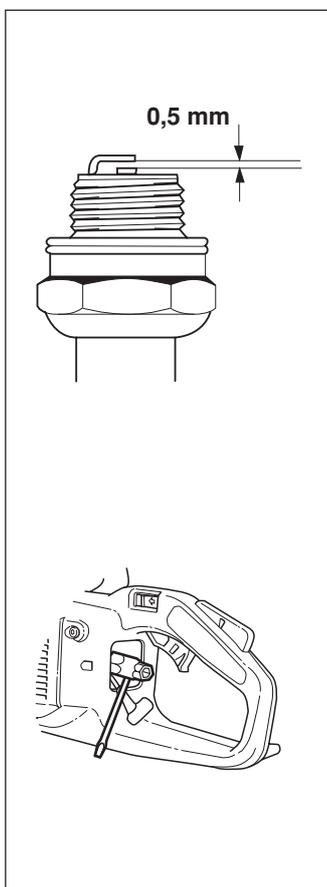
REMARQUE: Utiliser toujours le type de bougie recommandé! Une bougie incorrecte peut endommager le piston/le cylindre.
