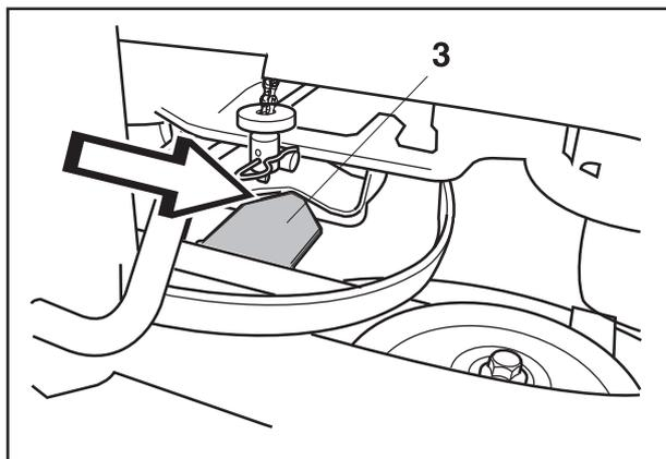
3. Placez le boulon et le serrer à l'aide d'une cheville de blocage.
