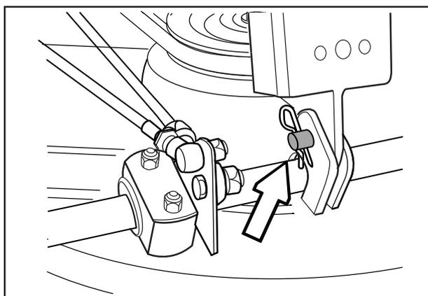
4. Appuyez sur le cadre et mettez en place la cheville. Placez la courroie d'entraînement autour de la roue d'entraînement du groupe.
