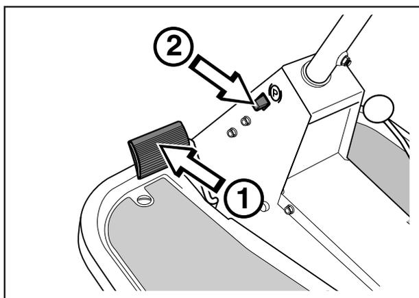
Le blocage du frein de stationnement est automatiquement déverrouillé en appuyant sur la pédale de frein.
