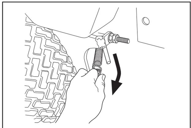
6. Posez un pied contre le bord avant du groupe, près de la roue, et soulevez le bord avant du groupe pour desserrer plus facilement le tirant de réglage de la hauteur.
