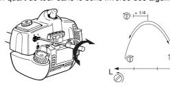
REMARQUE! Si l'équipement de coupe tourne au ralenti, tourner le pointeau de ralenti T dans le sens contraire des aiguilles jusqu'à l'arrêt de l'équipement de coupe.
