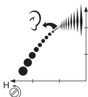
Le moteur ne doit pas être chargé lors du réglage du pointeau haut-régime H. Démontez l'équipement de coupe, l'écrou, la bride de support et le toc d'entraînement avant d'effectuer le réglage du pointeau haut-régime H.
