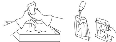
Un filtre ayant servi longtemps ne peut plus être complètement nettoyé. Le filtre à air doit donc être remplacé à intervalles réguliers. **Tout filtre endommagé doit être remplacé immédiatement.**
