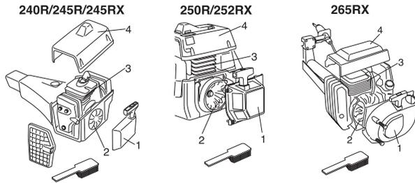
Le système de refroidissement est composé des éléments suivants:
