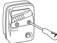
Si le silencieux de la machine est muni d'une grille antiflamme, il faut le nettoyer régulièrement. Une grille antiflamme bouchée entraîne une surchauffe du moteur pouvant provoquer des dommages graves.
