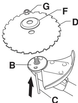
Les dents de la lame d'éclaircissage risquent de causer des blessures aussi bien lors du serrage que du desserrage de l'écrou de la lame. Veiller à ce que la main soit toujours protégée par le protège-lame lors de ces interventions. Toujours utiliser une clé à douille munie d'un manche assez long. La flèche sur l'illustration indique la zone dans laquelle la clé doit être utilisée, aussi bien pour serrer que pour desserrer l'écrou.
