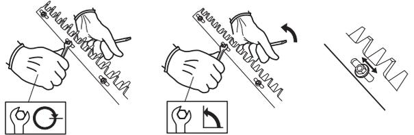
Lorsque les lames sont réglées correctement, un jeu de 0,2-0,4 mm entre les lames doit pouvoir être mesuré au niveau des vis. Les dents des couteaux sont trop dures pour pouvoir être limées. Utiliser une meuleuse pour affûter les couteaux émoussés. Remplacer les couteaux s'ils sont courbés ou endommagés.
