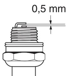
**REMARQUE!** Toujours utiliser le type de bougie recommandé! Une bougie incorrecte peut endommager le piston/le cylindre.
