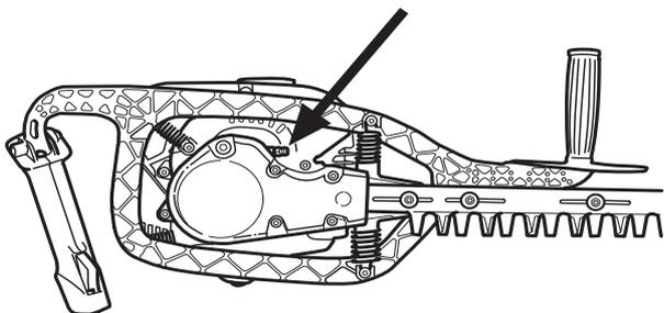
**REMARQUE!** L'engrenage ne doit pas être entièrement rempli de lubrifiant. Le lubrifiant se dilate sous l'effet de la chaleur qui se dégage lors du fonctionnement de la machine. Si l'engrenage est entièrement rempli de lubrifiant, les joints d'étanchéité risquent d'être endommagés, entraînant des fuites de lubrifiant.
