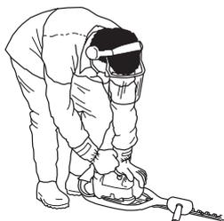
Dès l'allumage du moteur, enfoncer le starter et continuer les essais de démarrage jusqu'au démarrage du moteur. Quand le moteur démarre, passer rapidement au plein régime et le ralenti accéléré est automatiquement désactivé.
