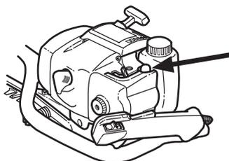
Plaquer la machine contre le sol à l'aide de la main gauche (NOTA! Pas à l'aide du pied!). Saisir ensuite la poignée de démarrage de la main droite et tirer lentement sur le lanceur jusqu'à ce qu'une résistance se fasse sentir (les cliquets d'entraînement grippent), puis tirer énergiquement et rapidement sur le lanceur.
