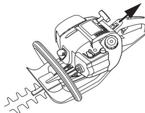
**Starter:** Ramener le starter sur la position starter (A). La position starter est également la position de ralenti accéléré automatique.
