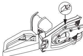
REMARQUE! L'engrenage ne doit pas être entièrement rempli de lubrifiant. Le lubrifiant se dilate sous l'effet de la chaleur qui se dégage lors du fonctionnement de la machine. Si l'engrenage est entièrement rempli de lubrifiant, les joints d'étanchéité risquent d'être endommagés, entraînant des fuites de lubrifiant.
