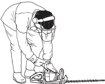
Dès l'allumage du moteur, enfoncer le starter et continuer les essais de démarrage jusqu'au démarrage du moteur. Quand le moteur démarre, passer rapidement au plein régime et le ralenti accéléré est automatiquement désactivé.
