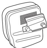
Sur les silencieux sans pot catalytique, la grille doit être nettoyée et si nécessaire remplacée une fois par semaine. Sur les machines dont le silencieux est muni d'un pot catalytique, la grille devra être inspectée et si nécessaire nettoyée une fois par mois. **Si la grille est abîmée, elle devra être remplacée.**
