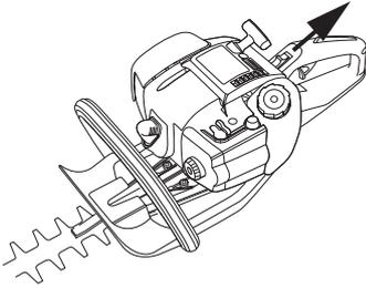
**Starter:** Amener le starter sur la position starter puis le remettre sur sa position de départ (B). De cette façon seul le ralenti accéléré est utilisé et pas le starter.
