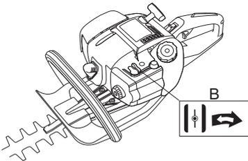
**Pompe à carburant:** Appuyer sur la poche en caoutchouc de la pompe à carburant plusieurs fois jusqu'à ce que le carburant commence à remplir la poche. Il n'est pas nécessaire de remplir la poche complètement.
