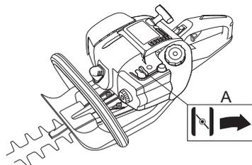
**Pompe à carburant:** Appuyer sur la poche en caoutchouc de la pompe à carburant plusieurs fois jusqu'à ce que le carburant commence à remplir la poche. Il n'est pas nécessaire de remplir la poche complètement.
