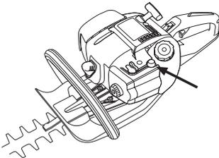
Plaquer la machine contre le sol à l'aide de la main gauche (NOTA! Pas à l'aide du pied!). Saisir ensuite la poignée de démarrage de la main droite et tirer lentement sur le lanceur jusqu'à ce qu'une résistance se fasse sentir (les cliquets d'entraînement grippent), puis tirer énergiquement et rapidement sur le lanceur.
