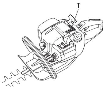
**REMARQUE!** S'il est impossible de régler le régime de ralenti de manière à immobiliser l'équipement de coupe, contacter le revendeur ou l'atelier de réparation. Ne pas utiliser la machine tant qu'elle n'est pas correctement réglée ou réparée.
